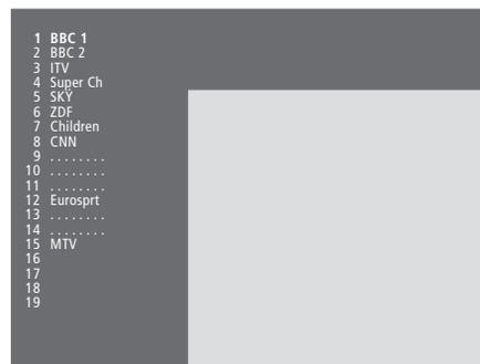
L'elenco dei canali TV. Le linee puntinate indicano che un canale è stato memorizzato, senza assegnargli nessun nome. Uno spazio vuoto nell'elenco indica che in quella posizione non è stato memorizzato nessun canale.
