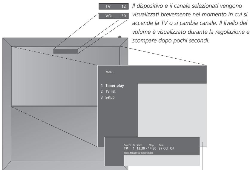
*Il dispositivo e il canale selezionati vengono visualizzati brevemente nel momento in cui si accende la TV o si cambia canale. Il livello del volume è visualizzato durante la regolazione e scompare dopo pochi secondi.*
